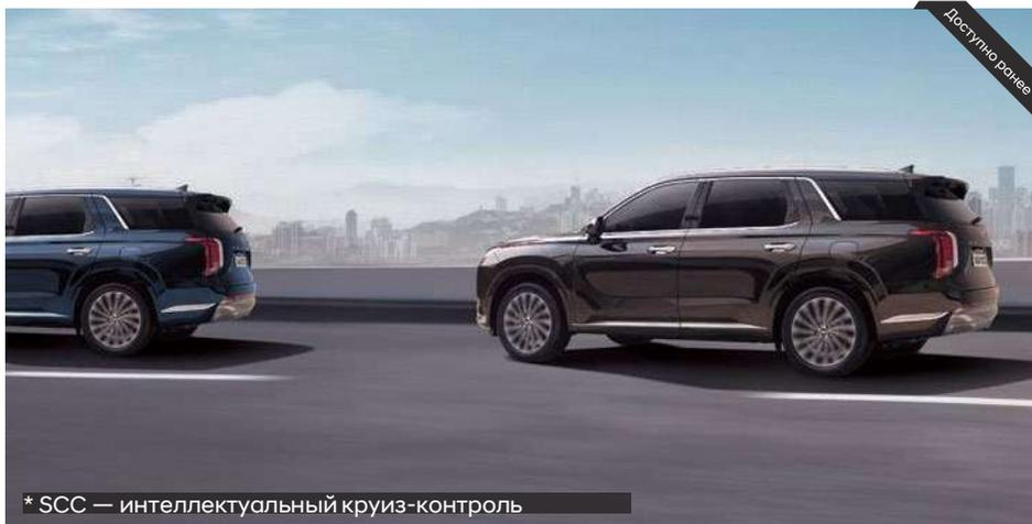
Помогает SUV двигаться со скоростью, заданной водителем, и при этом поддерживает безопасную дистанцию от автомобиля, находящегося впереди. Автоматически прекращает движение SUV, если автомобиль впереди останавливается, и автоматически возобновляет движение после того, как этот автомобиль трогается с места.
