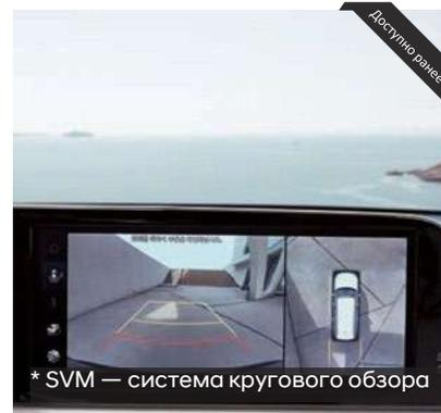
Отображение области вокруг автомобиля для безопасной парковки.
