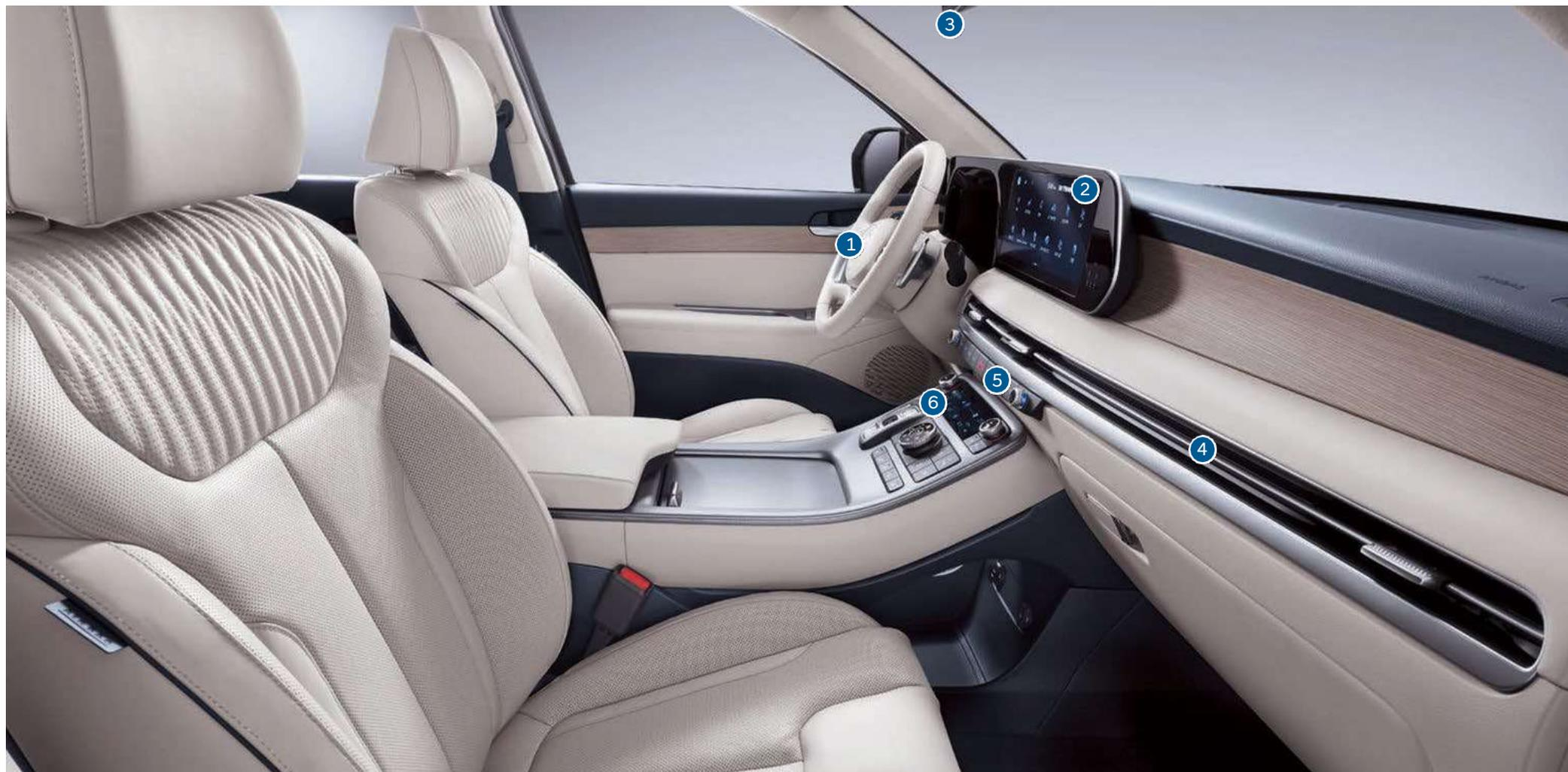
Среди особенностей обновленного Palisade — большой дисплей диагональю 12,3 дюйма и интегрированные узкие дефлекторы
